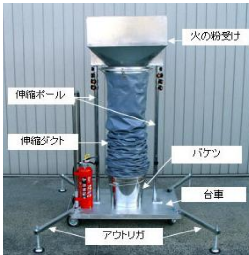
（火の粉養生装置「スパークタワー」）
