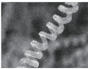
カーボンナノコイルは、らせん状をしたカーボンナノチューブで、ナノチューブと同様の電気的・機械的特性に加え、電磁波吸収等に非常に優れた特性を有します。
